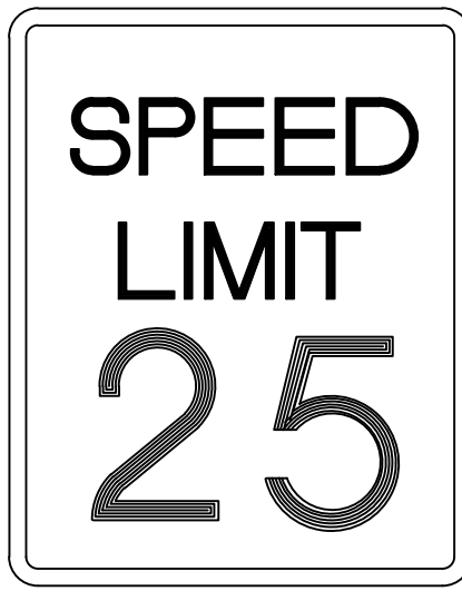
R2-1 SPEED LIMIT SIGN DETAIL N.T.S.
